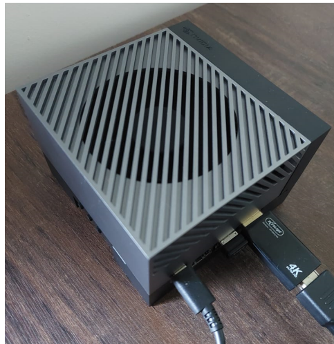
Figura 20 – Dispositivo Jetson AGX Orin
